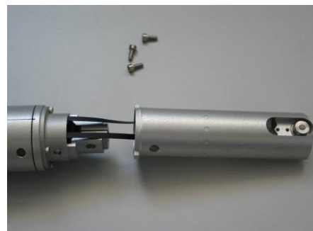
Zdjęcie 3. Demontaż mostka DRT
